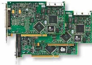
Şekil 2.a. PCI6024E AD/DA Veri Toplama Kartı
